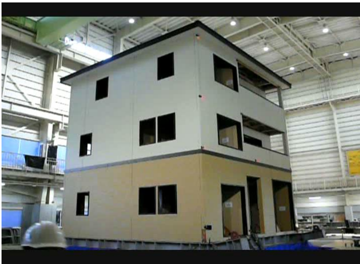
3階建て軸組構法 (日加共同研究)
