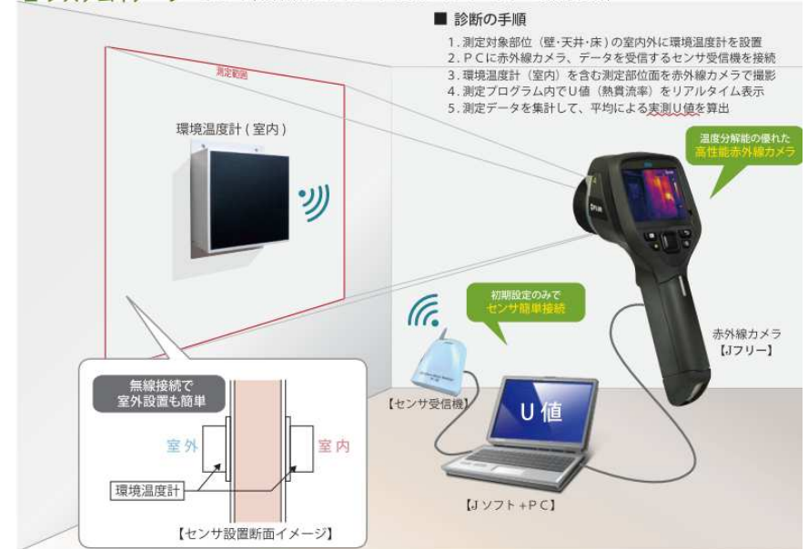
■ システムイメージ 各センサ、赤外線カメラのデータをオリジナルプログラムで集約し計算
